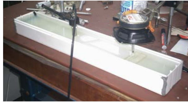
Fig.15a Se muestra la “guía de ondas” rectangular. El pistón apoyado en una barra de acrílico sobre la superficie del gel para no dañarlo. En el punto donde se encuentra el transductor incidía el haz laser antes de agregarle agua.
